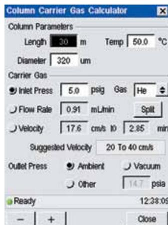
El exclusivo calculador de flujo de PerkinElmer, integrado en el sistema, determina la velocidad de flujo para una columna, con una longitud y diámetro determinados.
