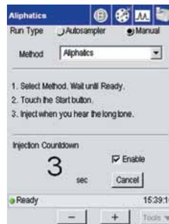
La cuenta atrás en la inyección asegura una alta precisión para inyecciones manuales de la muestra.
