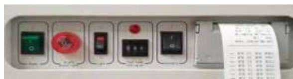
Panel de comando lateral con alarma visual y acústica. Incorpora impresora
