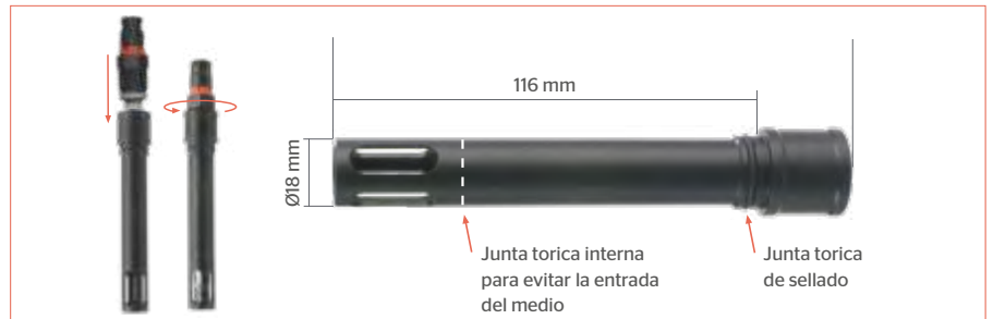
KP-ZU1054 - Protector para sensores con rosca PG13.5 (KP-SE706X/1-NMSN)
